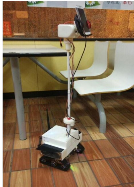
(图 2 机器人管家原型机脖颈升高图片)
